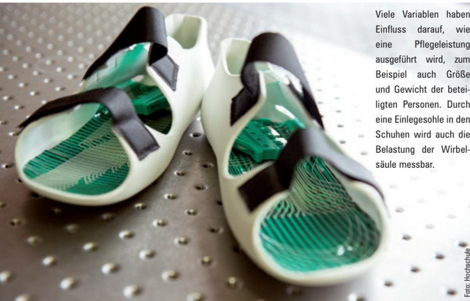
Viele Variablen haben Einfluss darauf, wie eine Pflegeleistung ausgeführt wird, zum Beispiel auch Größe und Gewicht der beteiligten Personen. Durch eine Einlegesohle in den Schuhen wird auch die Belastung der Wirbelsäule messbar.
