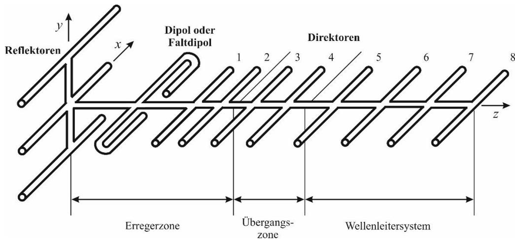
Eine Yagi-Uda-Antenne besteht aus einem aktiv gespeisten Dipol (oder Faltdipol) und parasitären Strahlerelementen für reflektierende und dirigierende Wirkung (Quelle: Prof. Dr. Kark).
